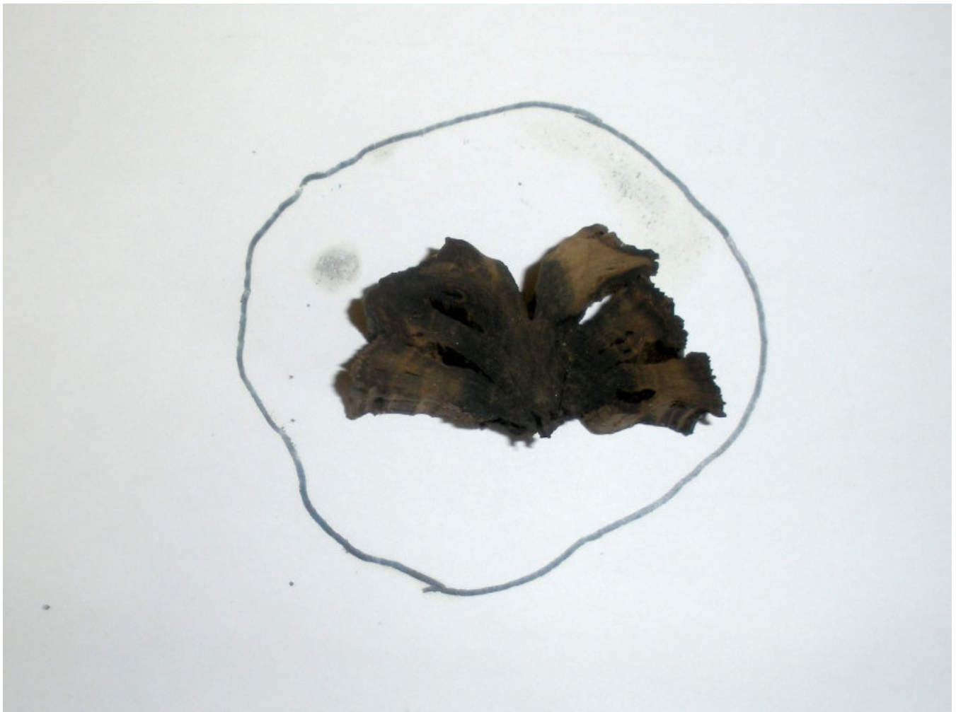
Fotografija testnega kosa lesa po končanem nekontroliranem sušenju na zraku in obris istega kosa lesa pred začetkom sušenja, foto: Katja Kavkler
